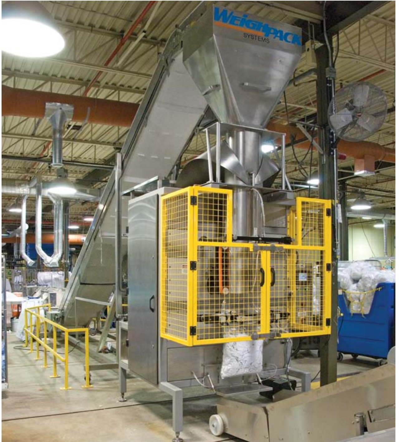
Qui aurait cru trouver une ensacheuse verticale dans une buanderie. Pourtant c'est chose faite depuis peu comme le raconte l'article apparaissant en page 13.
