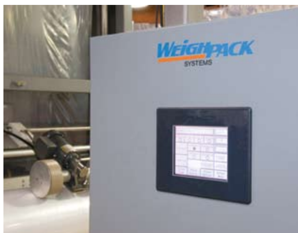
Panneau de contrôle de l'ensacheuse.
