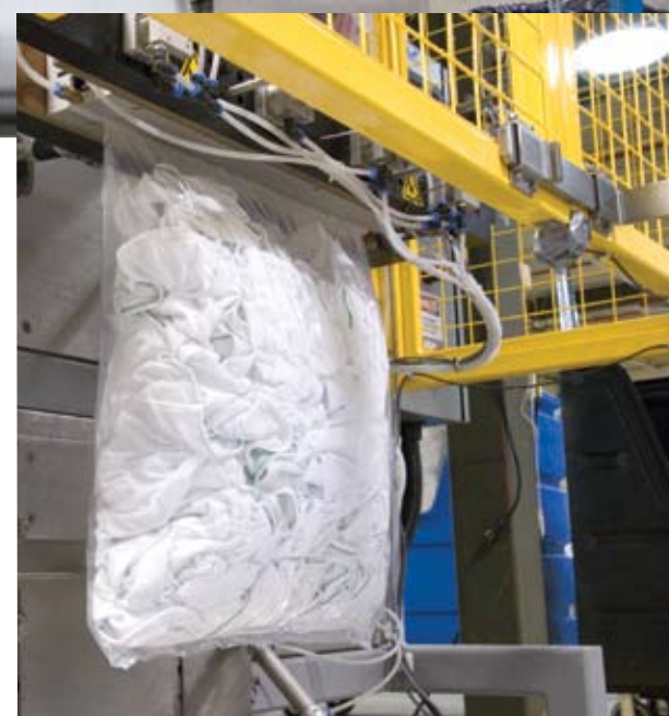
L'ensacheuse forme des sacs pesant jusqu'à 5 kilos.
