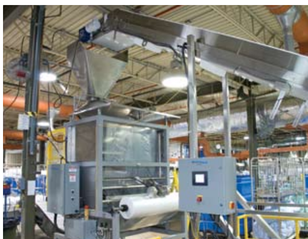
Un convoyeur ascendant alimente l'ensacheuse.
