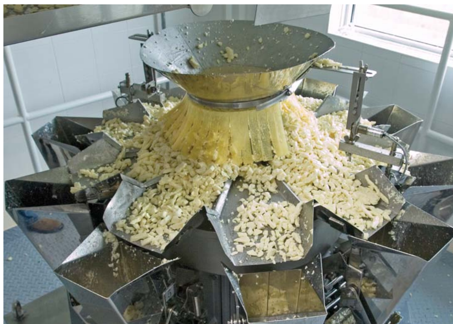
Vue d'ensemble de la balance Combi Scale à dix têtes.
