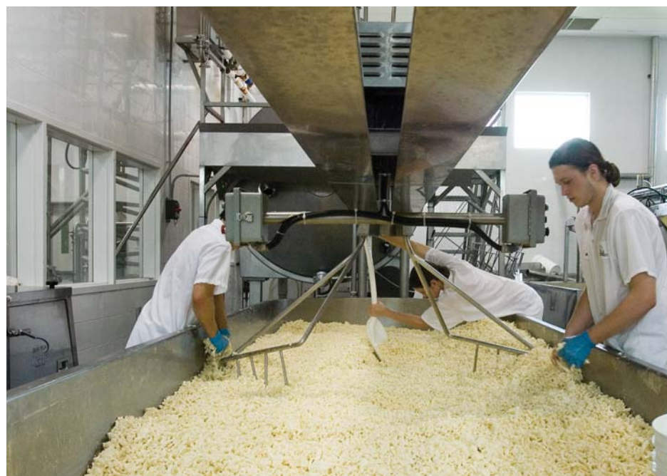
Un des deux bassins servant à la fabrication du cheddar en grains.
